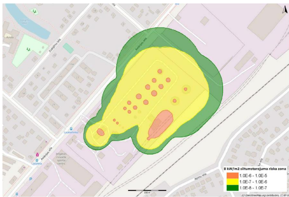
22. a ttēls. Siltumstarojuma zonas SIA “DANFORT” Jelga vas naftas bāzē [SIA “DANFORT” Jelga vas naftas bāzes rūpniecisko a vāriju riska novērtējums, SIA “PSI” risks un audits, 2017]
